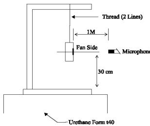
1METER FROM MICROPHONE TO FAN INTAKE
